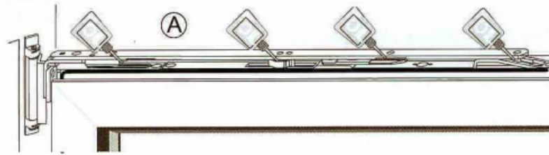
Abb. 1 Die Schere sollte einmal jährlich an allen Kontaktstellen mit der Oberschiene geölt werden. Dazu an die in Abb. 1 gezeigten Positionen einige Tropfen harz- und säurefreies Öl träufeln.
